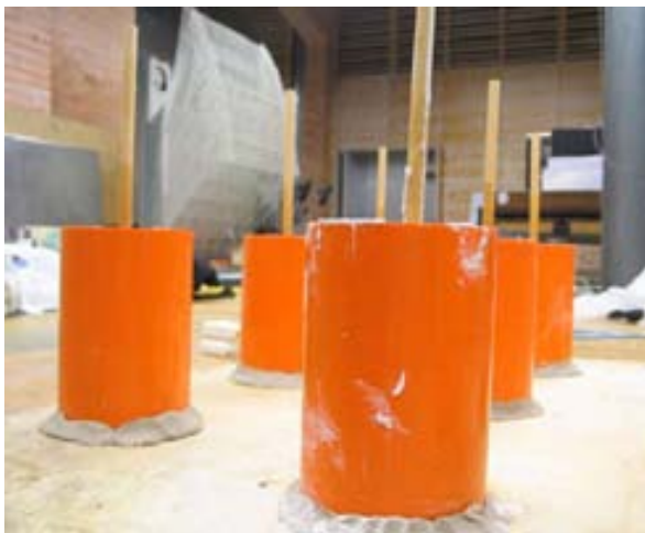
Fasi realizzative delle basi. Dall'alto: applicazione della vaselina per la successiva estrazione dello stampo; posizionamento dei bastoncini al centro; gli stampi fissati sul piano pronti per essere riempiti; preparazione del gesso; gli stampi dopo la colata; le basi definitive e rifinite.
